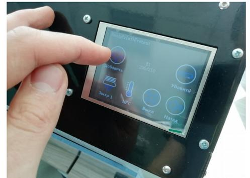
5. Используя раздел «Нить» на мониторе подавайте пруток в экструдер пока не пойдет новый материал из сопла. При необходимости, подтолкните пруток рукой, пока его не зацепит механизм подачи.
